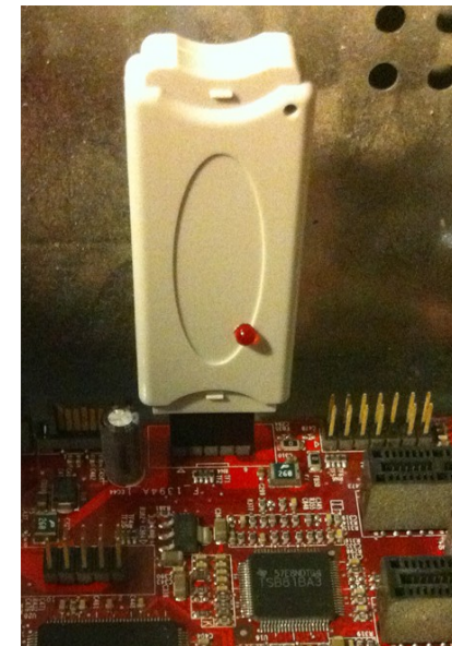
Рисунок 2: Установка ключа CVS-USBKey внутри системного блока компьютера.
