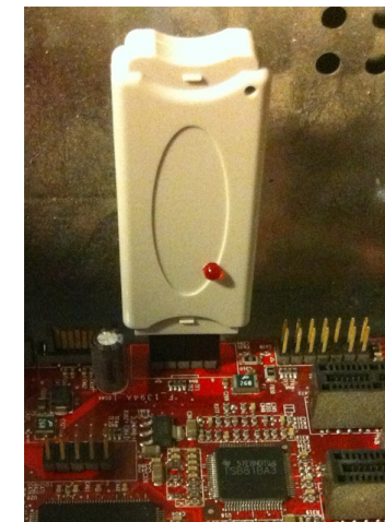
Рис. 2: Установка ключа CVS-USBKey внутри системного блока компьютера.
