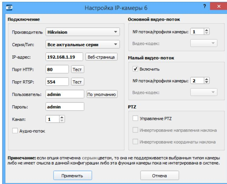
Рисунок 2: Подключение к камерам IP видеокодера.
